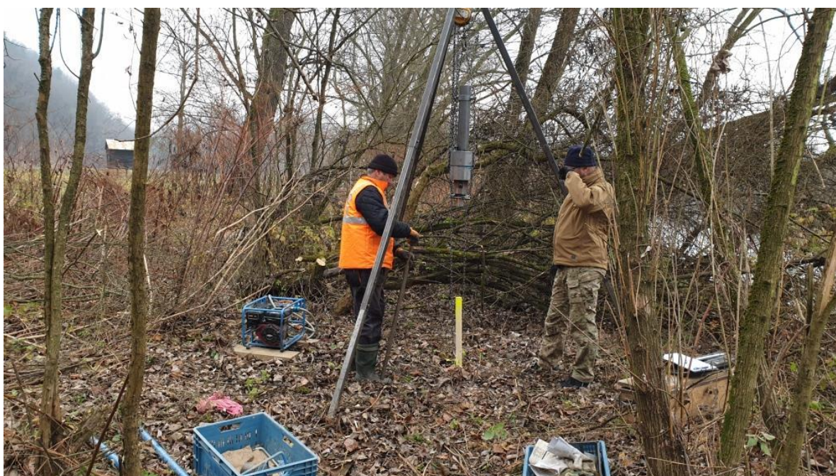
Obr. 2: Ukážka z realizácie penetračnej sondy na pravom brehu Váhu
